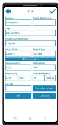
Messstellen-Stammdaten auf einen Blick
